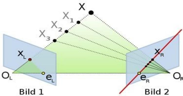
Danach wird über die Punkte  $O_L$ ,  $O_R$  und  $X$  eine Ebene gebildet. Die Linie, welche sich durch den Schnitt mit den Bildern ergibt wird Epipolarlinie genannt. Jetzt wird die Suche nach dem Pixel  $X_R$ , der mit  $X_L$  korrespondiert auf diese Linie Beschränkt.
